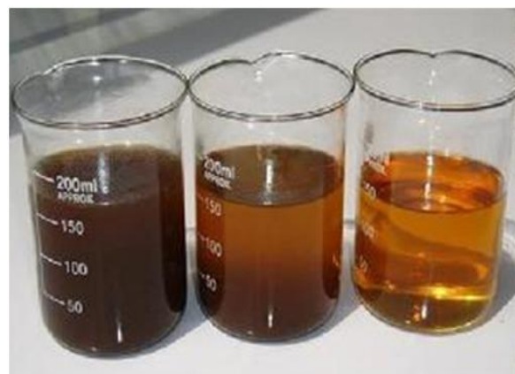
شکل ۱: نمونه‌های روغن پسماند خانگی، تجاری - خدماتی و صنعتی (به ترتیب از راست به چپ)
