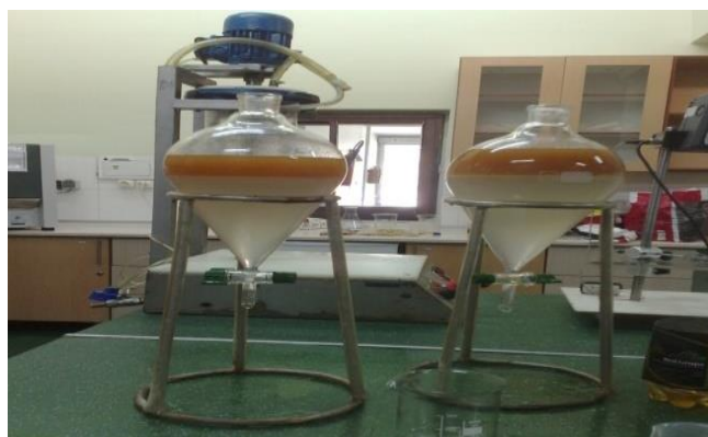
شکل ۳: استفاده از روش آبشویی برای خالص‌سازی بیودیزل‌های تولیدی
