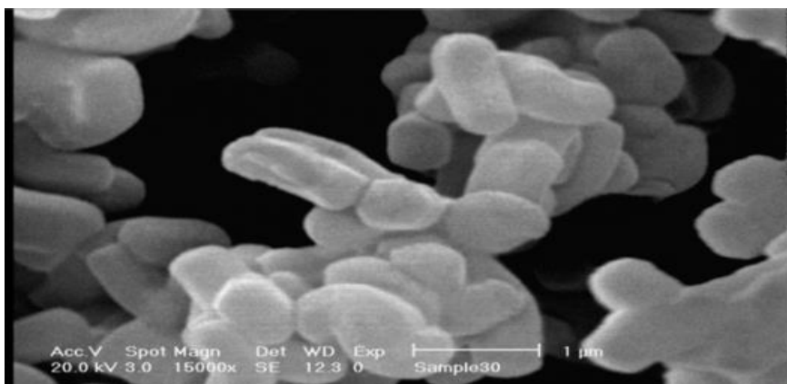
نمودار ۳: تصویر میکروسکوپ الکترونی نگهدارنده (SEM) نانوجاذب SBA-15 هگزاگونال کلسینه شده (بزرگ‌نمایی \times 15000 )
